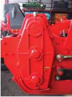
※サイドトランスミッションはギヤドライブで丈夫です。
